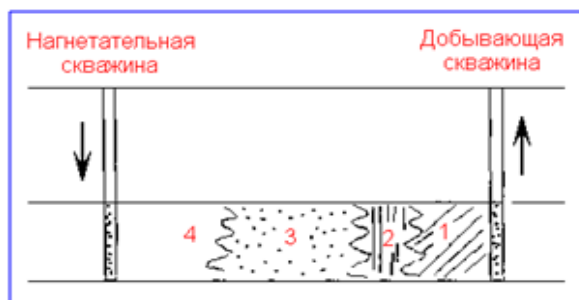
Сурет 1.8 - \text{CO}_2 айдау схемасы
