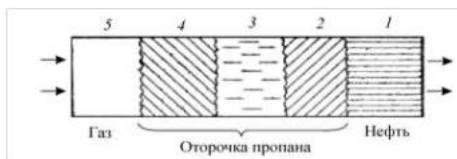
Сурет 1.7 - Мұнайды сұйық пропанмен ығыстыру кезінде көмірсутектердің таралуы
